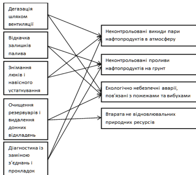
Рис. 1. Етапи підготовки резервуару до проведення регламентних робіт і їх екологічна небезпека
