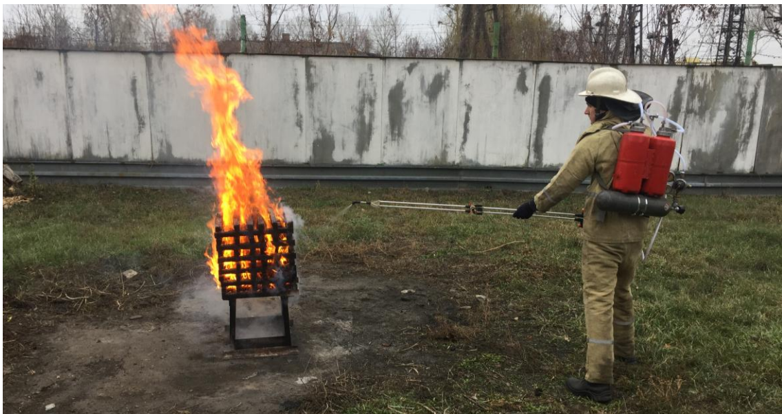
Рис. 3. Гасіння модельного вогнища 1А установкою гасіння гелеутворюючими складами з подовженим стволом колінчастого типу
