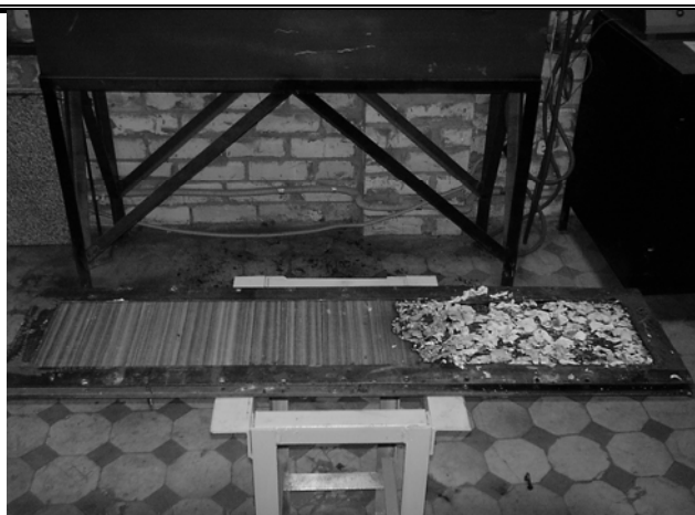
Рис. 2 – Зовнішній вигляд зразка ДВП що занурювався у воду (КПГТП 4,5 кВт/м 2 ) після випробувань
