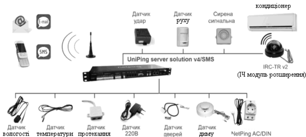
Рисунок 3 – Можливості підключення датчиків
