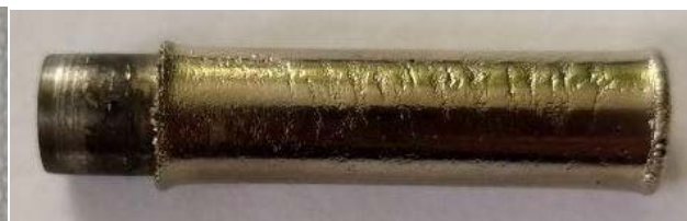
Рис.5. Експериментальні (1) та змодельовані (2) профілі катодних осадів (а, б).
