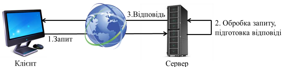
Рисунок 8.1 – Архітектура роботи клієнт-серверної технології
