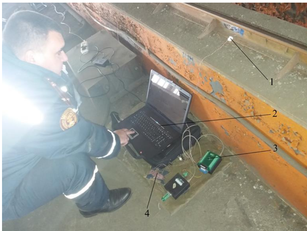
Рис. 1. Загальний вигляд вимірювального обладнання: 1 – клемна колодка; 2 – електронно-обчислювальна машина (ЕОМ); 3 – АЦП; 4 – напівмостова схема підключення
