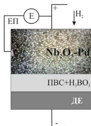
Рисунок 1. Схема індикаторного електрода сенсорної системи для детектування водню
