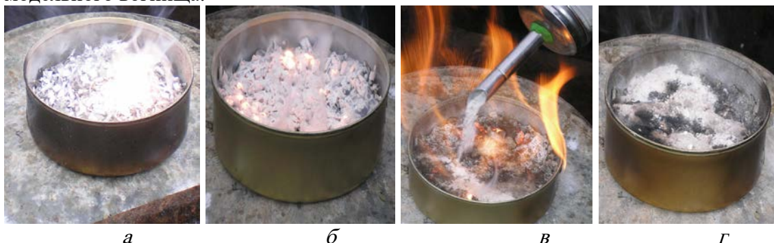
Рис 2. Гасіння полум'я магнію модельним зразком суміші: а – займання магнію; б – процес горіння магнію, в- подача вогнегасного засобу на полум'я магнію; г – затухання полум'я магнію.
