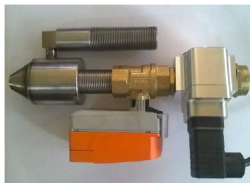
Рис. 2. Дослідницький зразок гідрокавітаційної форсунки
