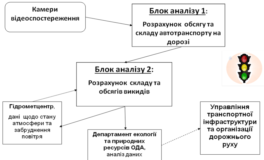
Рис. 1 Схема передачі та обробки інформації для визначення обсягів викидів забруднюючих речовин від автотранспорту
