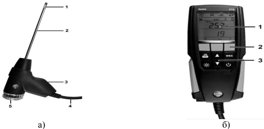
Рисунок 2 – а) Зонд відбору проби продуктів згорання: 1 – термопара; 2 – корпус зонда; 3 – рукоятка зонда; 4 – кабель; 5 – камера змінного фільтра (контрольне вікно, фракційний фільтр і ущільнювальна заглушка для вимірювання диференціального тиску); б) Вимірювальний пристрій: 1 – дисплей; 2 – функціональні кнопки; 3 – панель кнопок.
