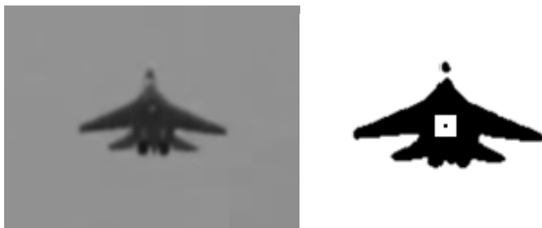
Рис. 4. Визначення координат об'єкта з використанням алгоритму аналізу гистограми
