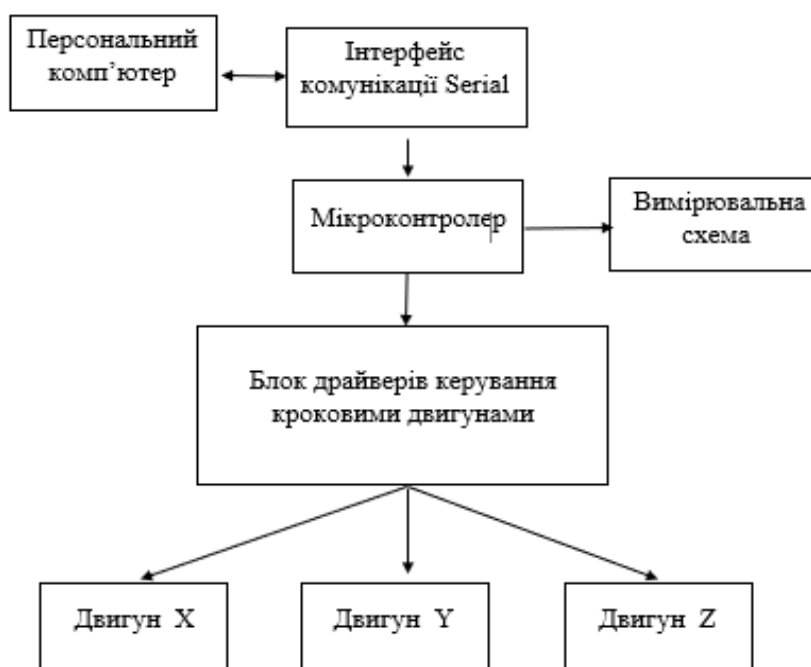
Рис. 1. Функціональна схема системи позиціонування для чотирьохзондового методу
