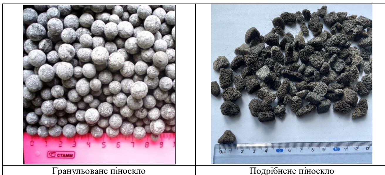
Рис. 1. Зовнішній вигляд гранульованого і подрібненого піноскла.
