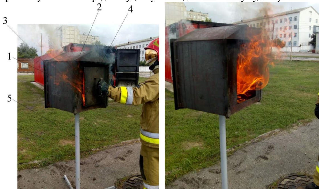
Рис. 1. Макет будинку для дослідження явищ пожеж: 1 – стіни будинку; 2 – дах будинку; 3 – з’ємна задня стінка для завантаження будинку твердим горючим матеріалом; 4 – кришка закриття переднього отвору для управління газообміном при розвитку пожежі; 5 – підставка макету будинку
