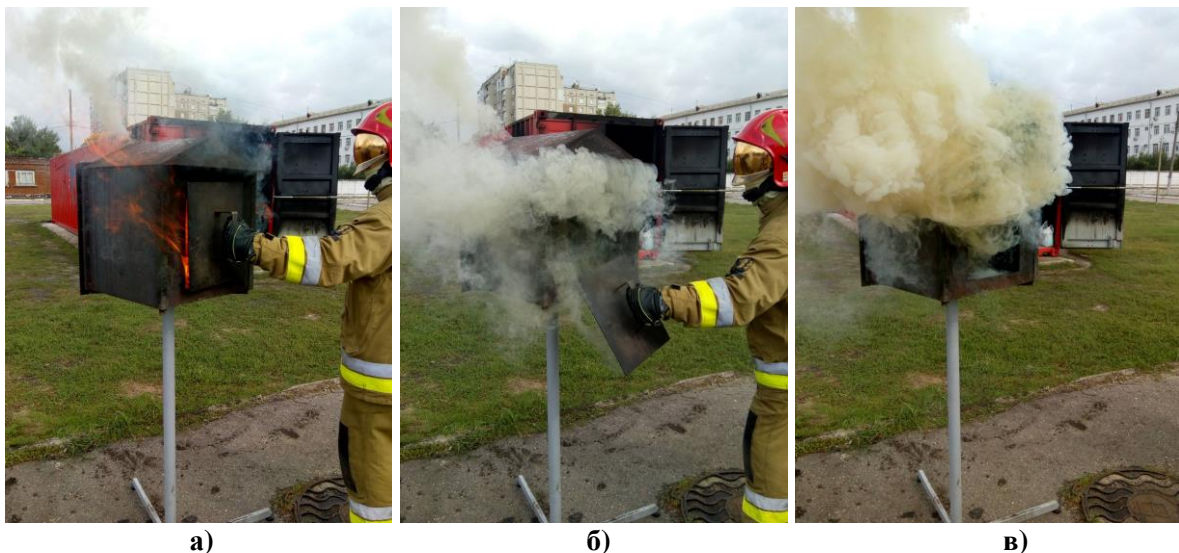
Рис. 3. Загальний вид управління газообміном при розвитку пожежі: а) – часткове відкриття та закриття кришкою переднього отвору будинку; б) – повне відкриття переднього отвору будинку; в) – насичення шару димових газів киснем
