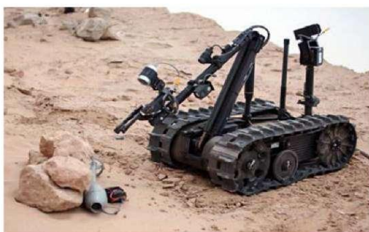
Рис. 1. Дистанційно керована машина «TALON».
