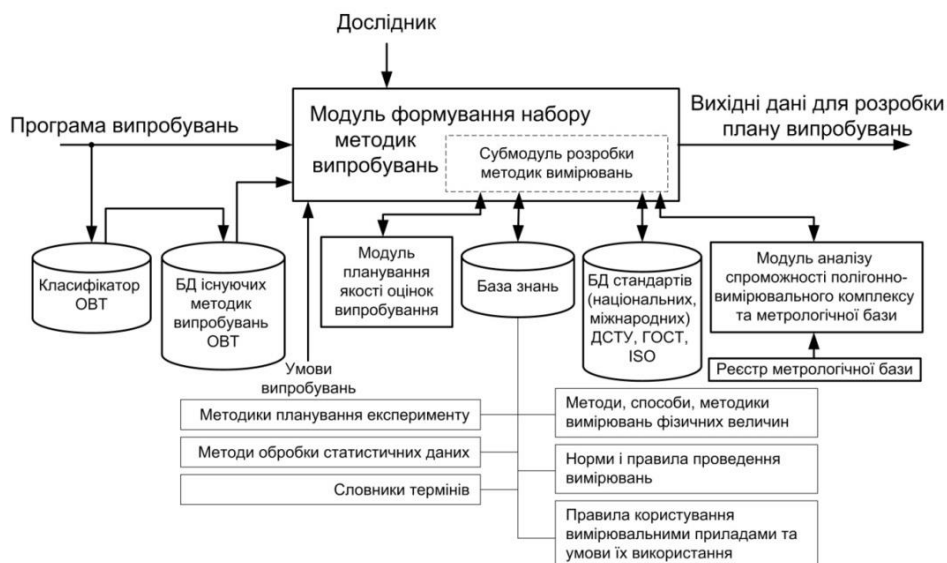
Рис. 2 – Структурно-функціональна схема модулю формування методик випробувань
