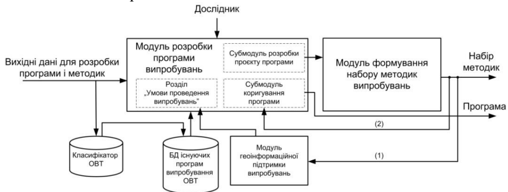
Рис. 1 – Структурно-функціональна схема модулю розробки програми випробувань
