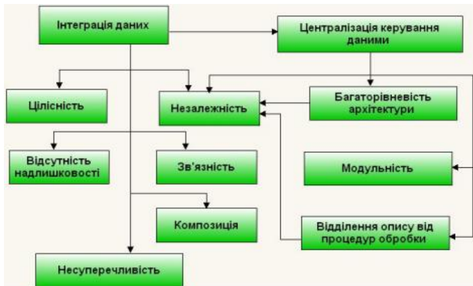
Рис.1 – Принципи проектування структури даних [2]
