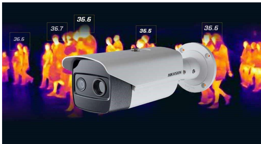
Рис.1 – Циліндрична камера від Hikvision із вбудованим тепловізором
