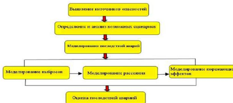
Рисунок 1 – Блок-схема процедуры, используемой для анализа последствий
