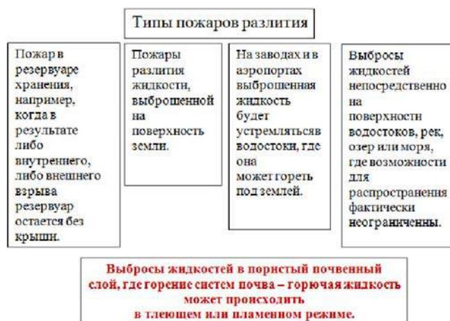
Рисунок 1 – Классификация пожаров разлития
