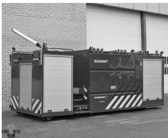
Рисунок 2. – Спеціальні контейнери Rosenbauer HFE-NH30
