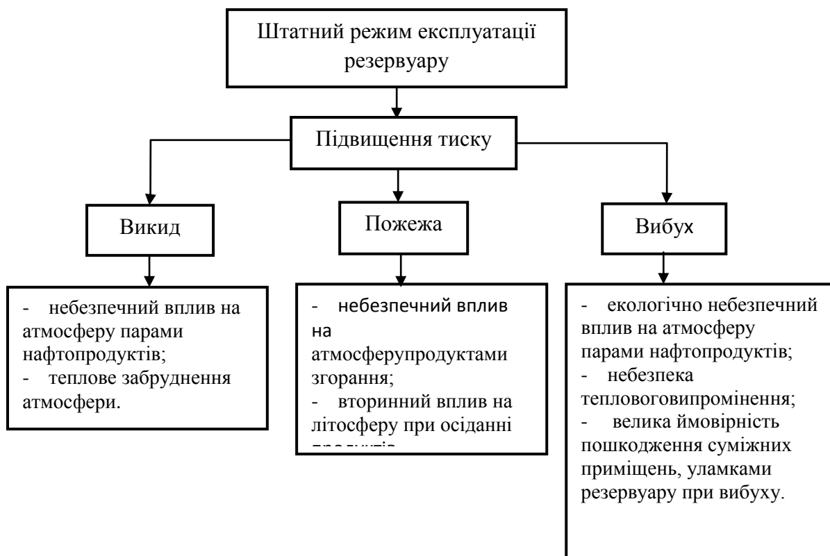
Рисунок 1 – Джерела пожежного та екологічного впливу за штатного режиму експлуатації резервуарів
