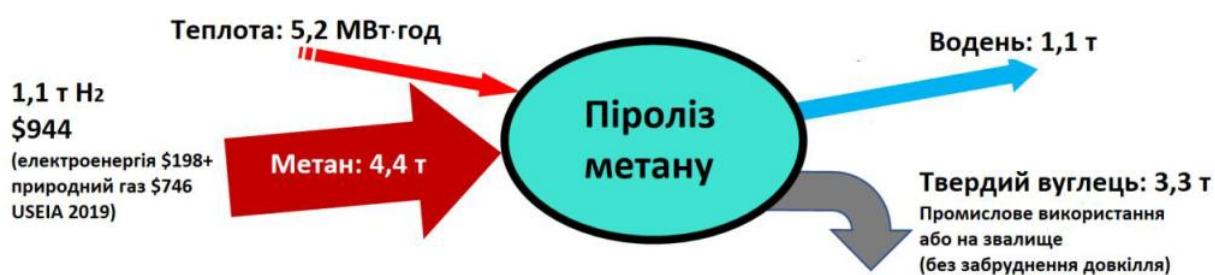
Рис. 2. Схема піролізу метану - ефективного одноетапного процесу виробництва водню без викидів парникових газів
