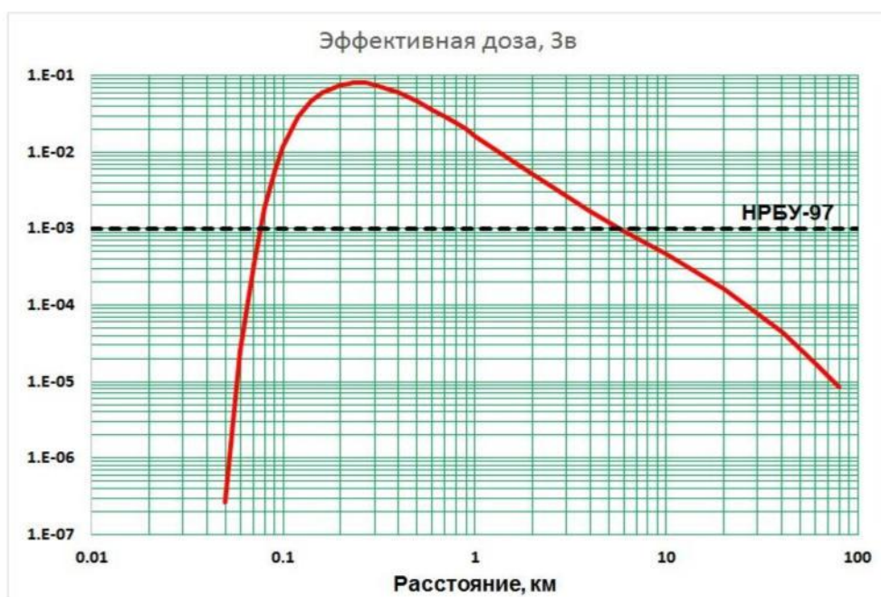
Рисунок 3 – Зависимость эффективной дозы на оси следа от расстояния. Пунктирная прямая показывает разрешенное значение согласно НРБУ-97
