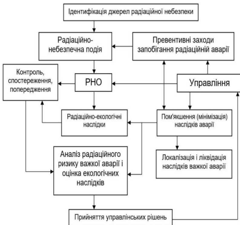
Рисунок 1 – Структурна схема контролю і керування важкими радіаційними аваріями
