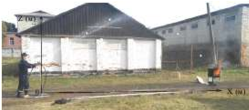
Рис. 2. Формування експериментальних даних для аналітичної побудови траєкторій руху струменів, що подаються з установки
