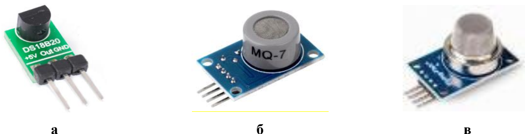
Рис. 4. Модулі вимірювальних датчиків: а – температури DS18B20; б – чадного газу MQ-7; в – диму MQ-2
