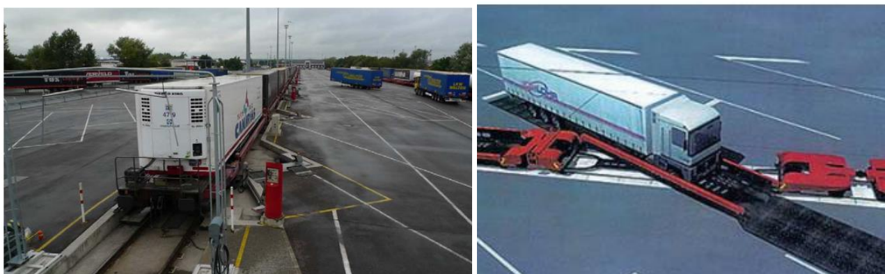
Рисунок 7 – Термінал Modalohr в м. Беттембург та схема завантаження
