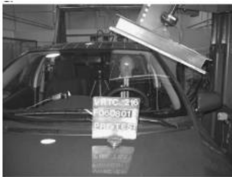
Рисунок 2 – Випробувальна установка на розчавлювання даху автомобіля по протоколу FMVSS 216.
