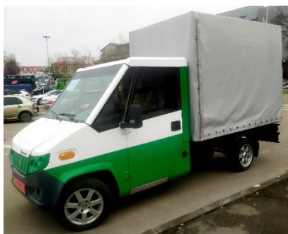
Рисунок 2 – Електромобіль з бортовим кузовом і тентом під час попередніх випробувань
