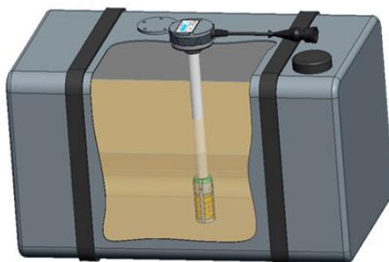
Рисунок 1 – Встановлення датчика рівня палива у бак
