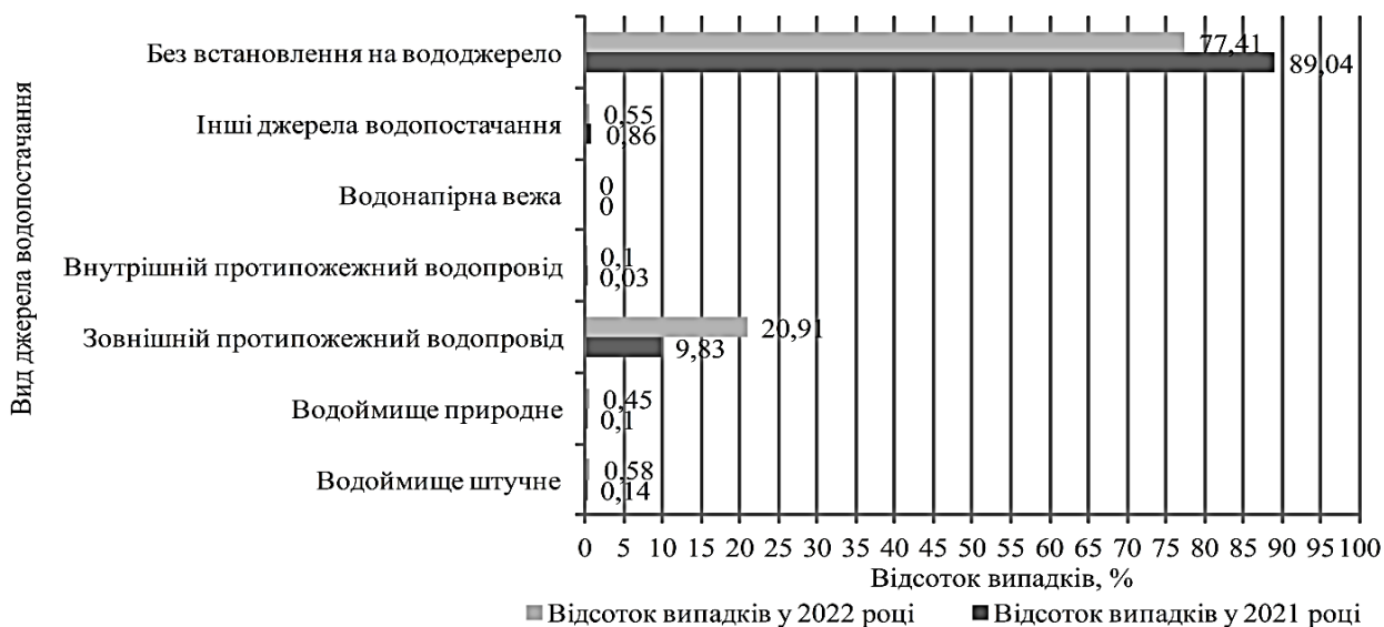
Рисунок 1 – Частота використання джерел водопостачання під час гасіння пожеж у відсотках
