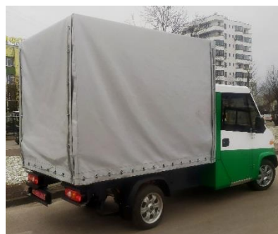
Рисунок 2 – Електромобіль з бортовим кузовом і тентом під час попередніх випробувань
