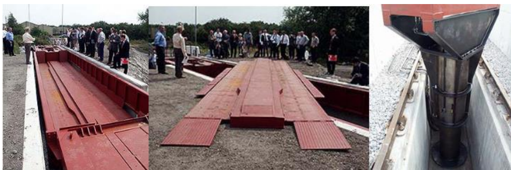
Рисунок 1– Основні робочі положення платформи системи CargoSpeed
