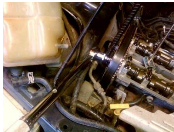
Рисунок 4 – Заміна ременя ГРМ на Zetec 1.6 Efi Dohc (ГУР, кондей).
