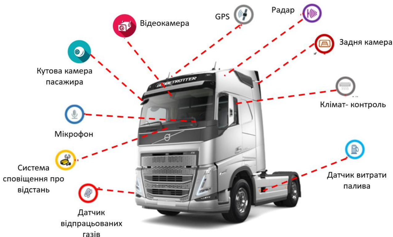
Рисунок 1 - Основні типи автомобільних датчиків
