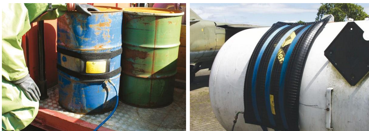
Рис. 4.11. Закриванням отворів на резервуарах за допомогою бандажів
