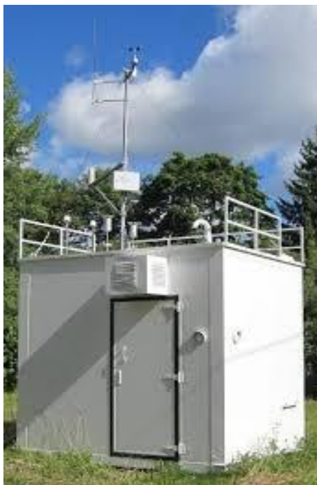
Рис. 4.1. Стационарний комплекс метеорологічного контролю та контролю хімічного стану повітря
