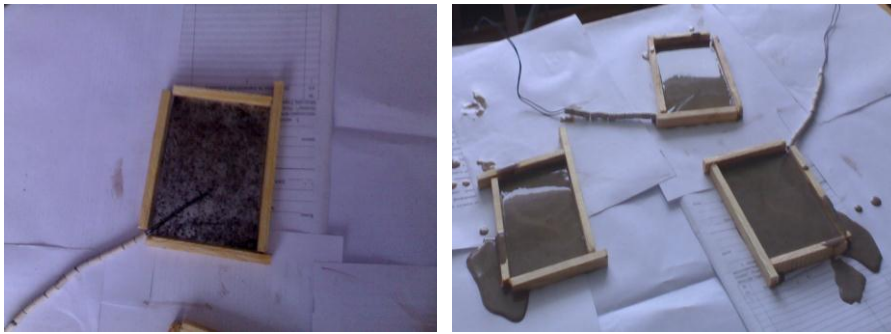
Рис. 1. Загальний вигляд сталевих пластин, покритих вогнезахисною речовиною
