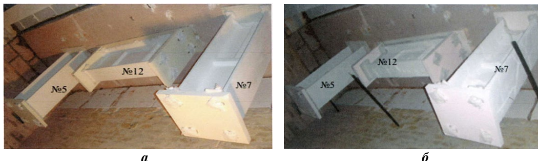
Рис. 2. Вогнезахисна сталева балка (№ 12) до (а) та після (б) проведення експерименту з мінімальним значенням товщини вогнезахисного покриття.
