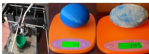
Рис.2 а) 3D друк сфери для доставки ВР; б) пуста сфера для доставки ВР; в) сфера з вогнегасним порошком для доставки в осередок пожежі
