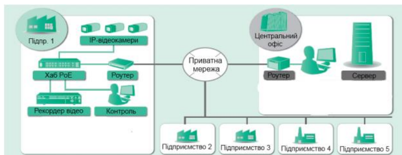
Рис. 2. Модель інтегрованого програмного забезпечення централізованого відеонагляду
