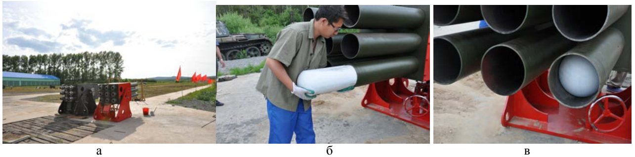
Рис. 3. Новые многоствольные модули и контейнеры для зарядки жидкости в ствол: а - общий вид модульной установки; б и в – фрагменты зарядки установки распылительными зарядами .
