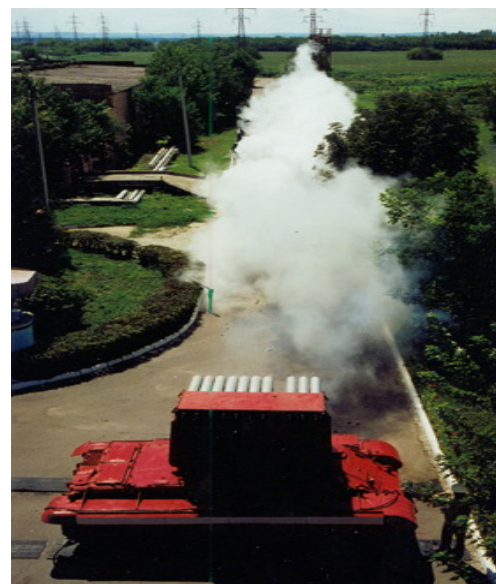
Рис. 2. Комплекс «Импульс-3м» обеспечивает возможность тушения пожара на отдалении до 110 м, площадь воздействия тушащими реагентами до 3000м 2
