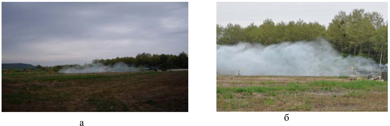
Рис. 4. а, б. Распыление 54л воды на дальность до 60-70м, ширина фронта газовойдыного шквала до 8м, высота 3,5м, «коридор» эффективного воздействия 1500–1700м 3 за 1сек - наиболее эффективный и масштабный способ осадить токсичные облака пыли, паров, газов. Машина «Импульс-3М», заряженная новыми контейнерами с водой, может сделать 16 таких залпов, осадив токсичное облако в объёме до 23000-25000м 3 за период 2-4 мин.
