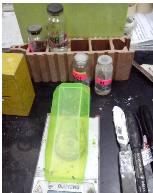
Рис.2. Вигляд бюксів із зразками, вагів та робочого місця при аналізі набухання та стійкості зразків у агресивних рідинах
