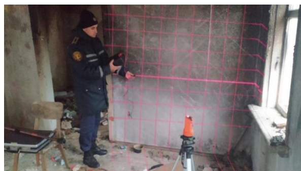
Рис. 3. Дослідження кіптяви в осередку надзвичайної ситуації датчиком для горизонтальних поверхонь з нанесеною на стіну лазерною розміткою
