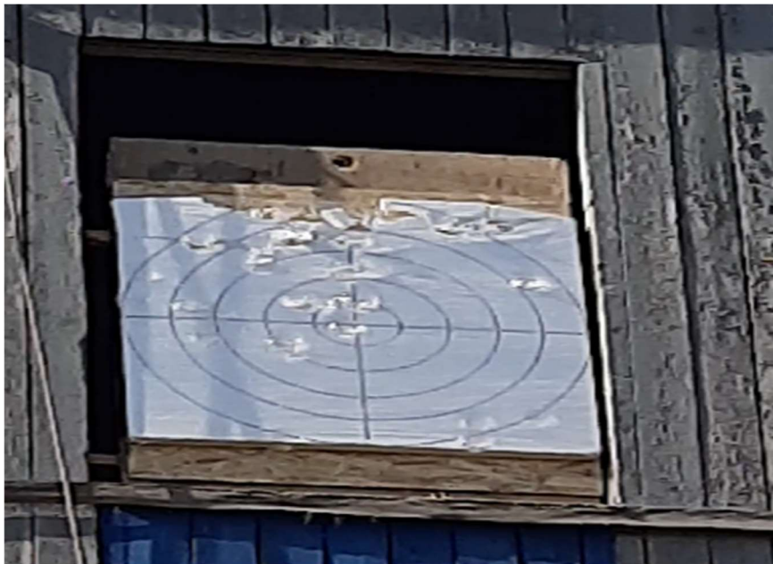
Рис. 3.10. Експериментальне дослідження купності дослідної установки дискретної подачі вогнегасних речовин у контейнерах 12 метрів до мішені
