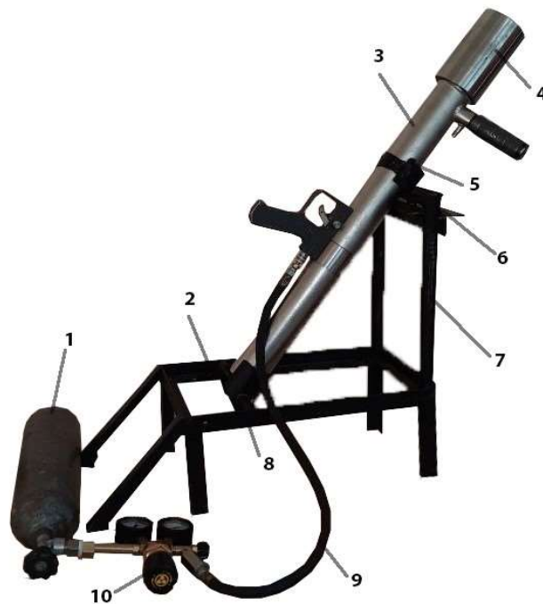
Рис. 2.8. Дослідна установка для дискретної подачі вогнегасних речовин у контейнері. Елементи: 1.Балон з стисненим повітрям. 2. Лафет для фіксування та зміни кута нахилу пневматичної гармати. 3. Ствол пневматичної гармати (імпульсної дії). 4.Насадок для контейнерів з вогнегасною речовиною. 5. Скоба фіксації ствола. 6. Регулююча планка по вертикалі кут нахилу ствола. 7. Вертикальна опора по якій переміщається регулююча планка. 8. Упорна регулююча основа зміни кута нахилу ствола по горизонталі. 9. Повітряний шланг. 10. Редуктор регулювання тиску у повітряній камері ствола
