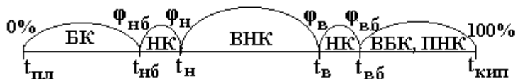
Рис. 3.2 – Температурна шкала пожежовибухонебезпеки горючих рідин: БК – область безпечних концентрацій насиченої пари; НК – небезпечних концентрацій пари; ВНК – вибухонебезпечних концентрацій пари; ВБК, ПНК – вибухобезпечних, але пожежонебезпечних концентрацій пари.
