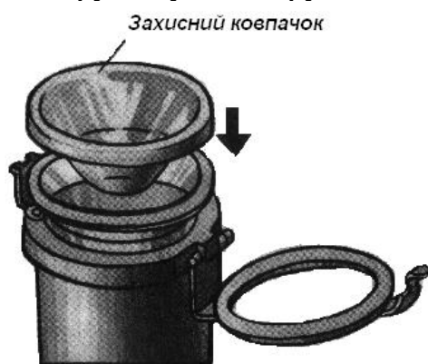
Рис. 1.11. Одягання захисного ковпачка в насадці приладу ВПХР
