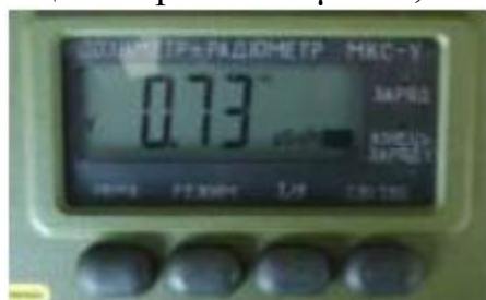
Рис. 2.26. Вимірювання ПЕД фотонного іонізуючого випромінювання ( \mu\text{Sv/h} ) за допомогою комбінованого блока детектування (КБД)
