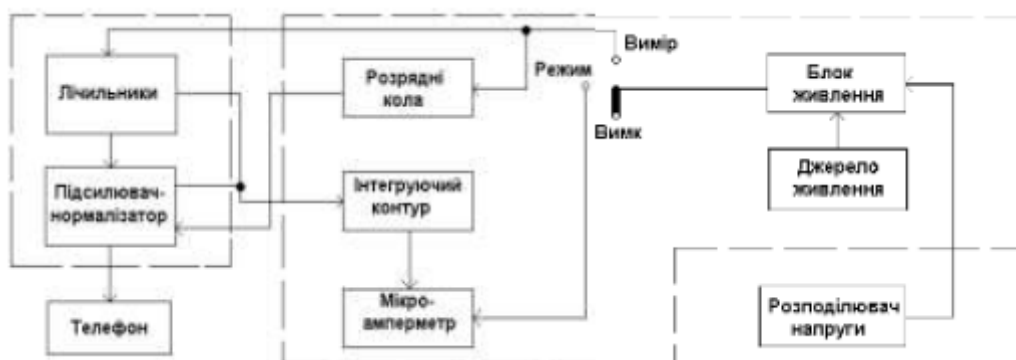
Рис. 2.8. Структурна схема приладу ДП-5В
