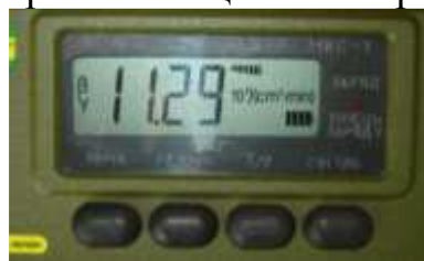
Рис. 2.27. Вимірювання щільності потоку бета-частинок
