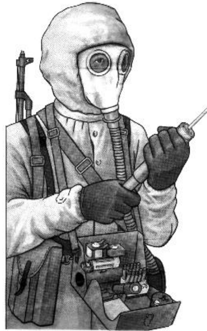
Рис. 1.5. Робоче положення приладу ВПХР під час визначення НХР у повітрі
