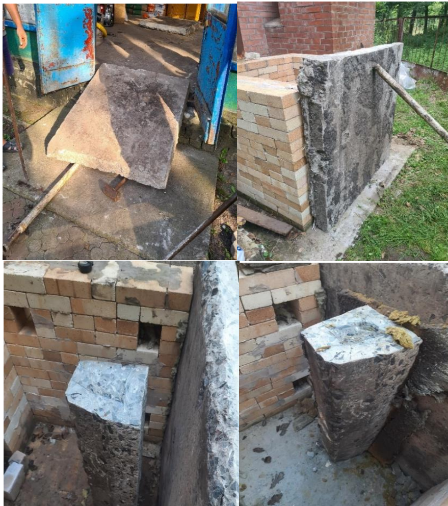
Рисунок 22 – Вигляд зразків фрагментів елементів несучих залізобетонних конструкцій під час підготовки до експериментальних досліджень впливу стандартного температурного режиму пожежі
