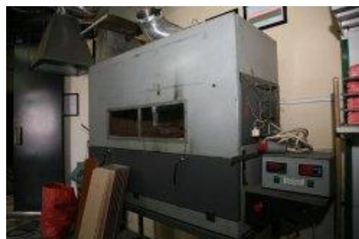
Рисунок 1.9 – Принципова схема приладу випробування матеріалів на поширення полум'я:
