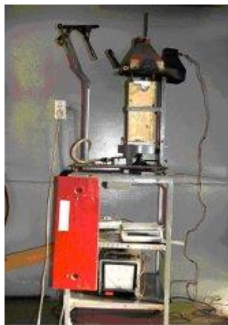
Рисунок 1.6 – Схема приладу «Вогнева труба» для випробувань будівельних матеріалів на горючість за методом І:
