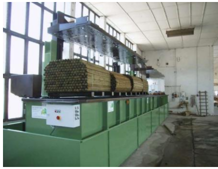
Рисунок 11.2 – Обладнання для просочування методом холодно-гарячих ванн
