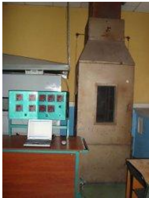
Рисунок 1.7 – Схема вертикальної шахтної печі для випробувань будівельних матеріалів на горючість за методом ІІ:
