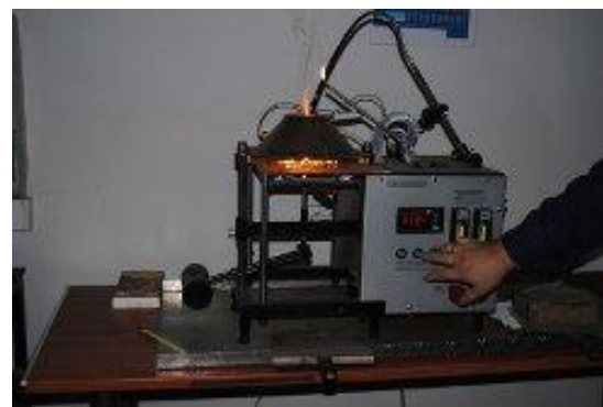
Рисунок 1.8 – Принципова схема приладу випробування матеріалів на займісткість (ДСТУ Б В.1.1-2-97):
