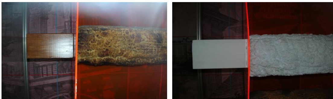
Рисунок 11.4 – Вогнезахисне покриття, що спучуються, для деревини
