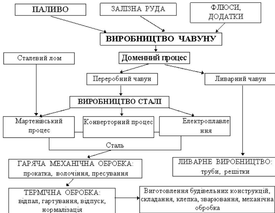
Рисунок 4.1 – Схема виробництва чорних металів та будівельних матеріалів із них
