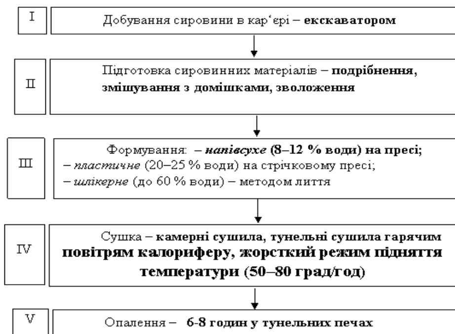
Рисунок 6.6 – Технологічна схема виробництва керамічних виробів
