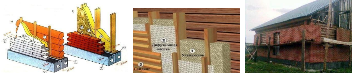
Рисунок 11.5 – Приклади екранування дерев'яних конструкцій
