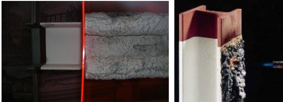
Рисунок 11.7 – Вогнезахисне покриття, що спучується, для металевих конструкцій
