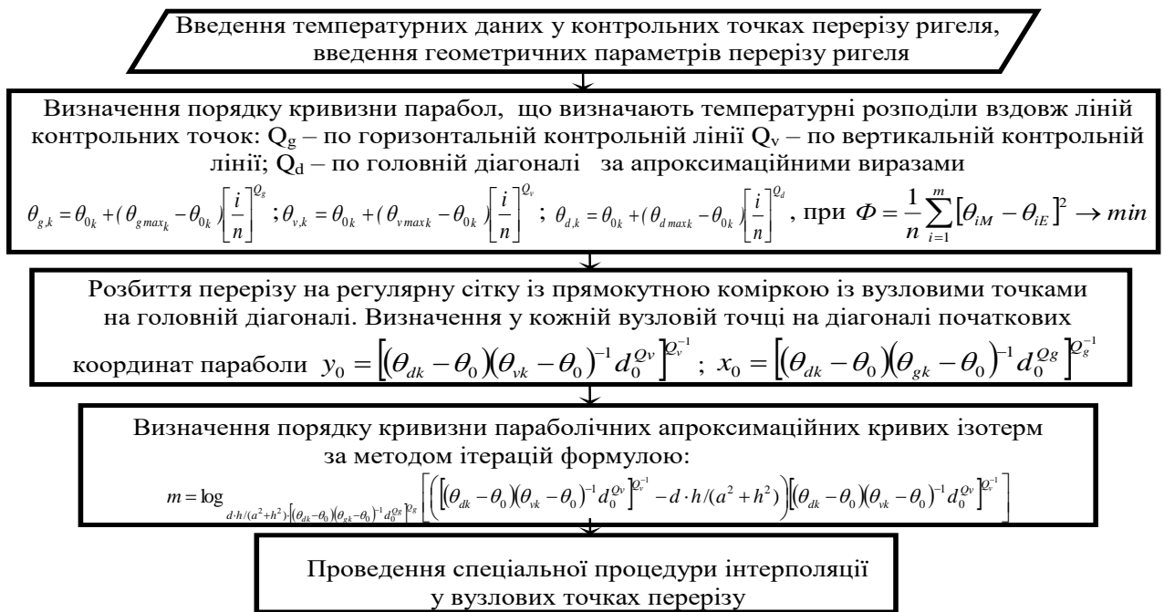
Рисунок 2. Алгоритм визначення температури у вузлових точках перерізу шляхом інтерполяції температур за температурними показниками у контрольних точках перерізу
