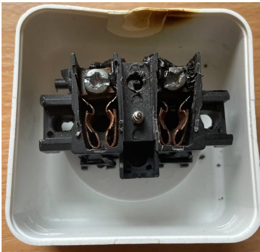
Рисунок 5.5. Вигляд обладнання, задіяного в експерименті (розетка без температурного запобіжника).
