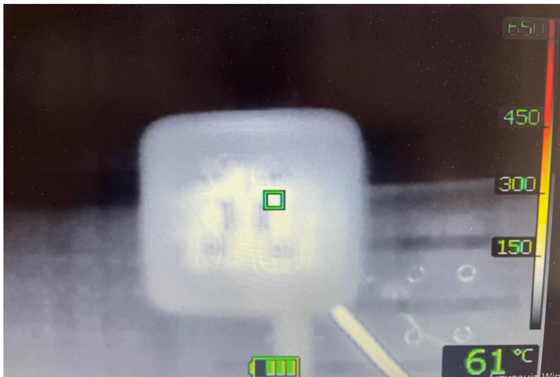
Рисунок 5.11. Розподіл температури в контрольному елементі електричного навантаження з окисленим штепселем та справним контактним з'єднанням розетки.
