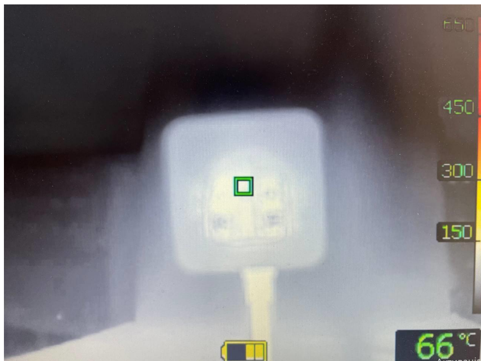
Рисунок 5.17. Розподіл температури в контрольному елементі електричного навантаження розетки із захистом та задовільним штепселем.
