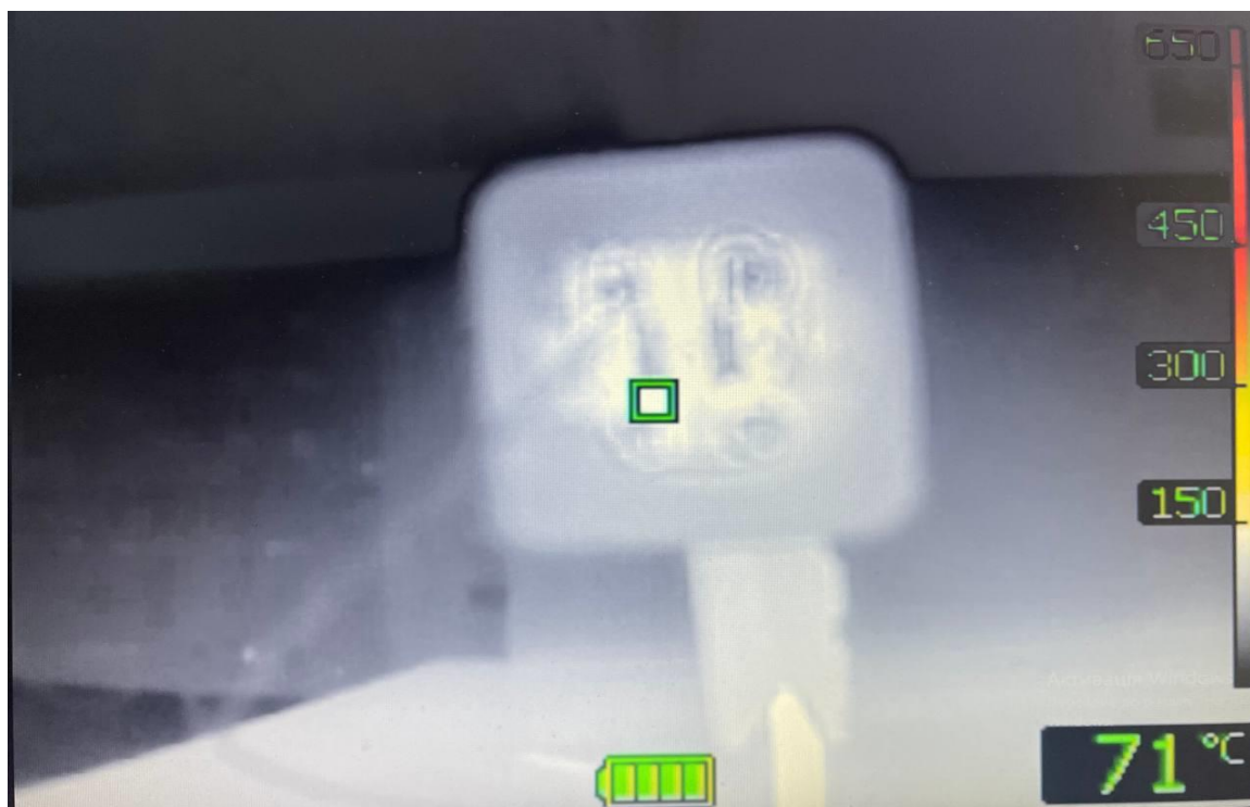
Рисунок 5.23. Розподіл температури в контрольному елементі електричного навантаження розетки з тепловим захистом та розігнутих контактом і окисленим штепселем.
