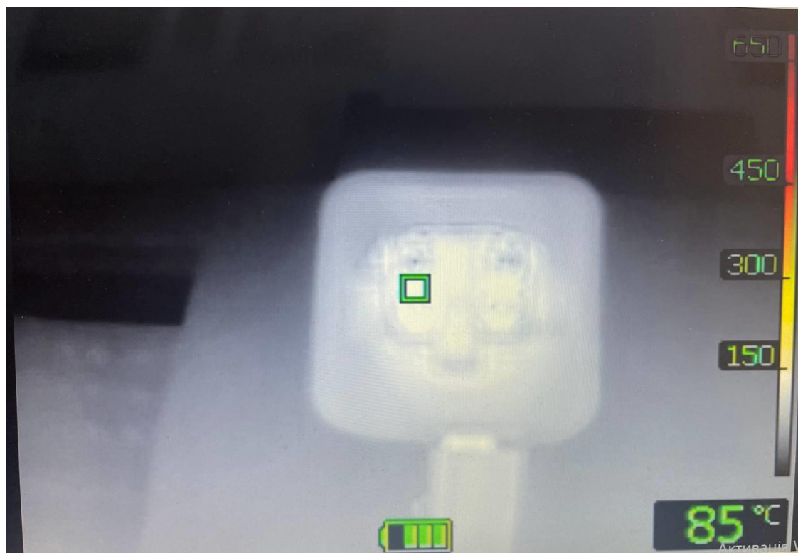
Рисунок 5.13. Розподіл температури в контрольному елементі з елементом електричного навантаження із задовільним штепселем та розігнутими контактними з'єднаннями розетки
