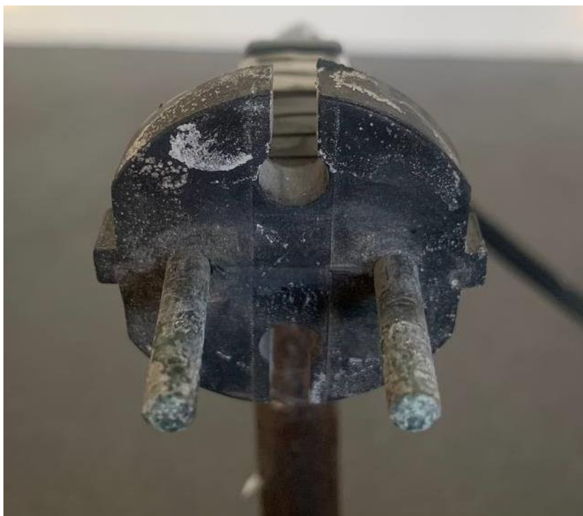
Рисунок 5.4. Вигляд обладнання, задіяного в експерименті (окислений штепсель).
