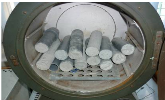
Рис. 2.7 – Циліндричні бетонні зразки діаметром 76 мм в формах і без форм в сушильній шафі СНОЛ 3,5.35.3,5/3М
