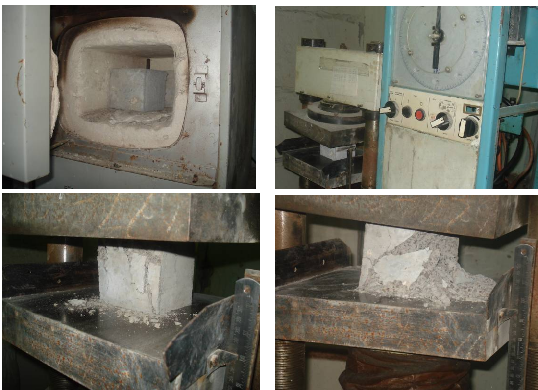
Рис. 4.1 – Процес проведення випробувань кубічних зразків з модифікованого бетону при їх стисненні в нагрітому стані
