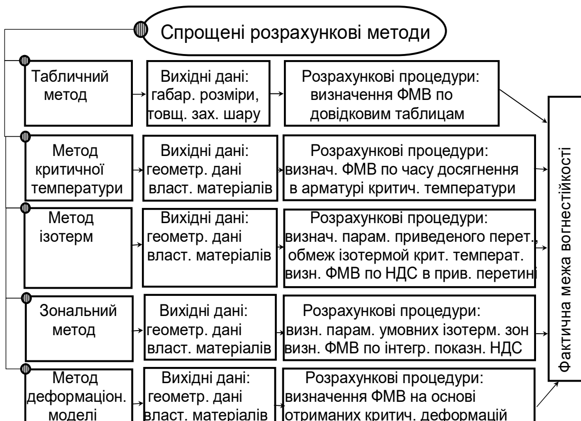
Рис. 1.5 – Структурна схема спрощених розрахункових методів визначення вогнестійкості залізобетонних конструкцій
