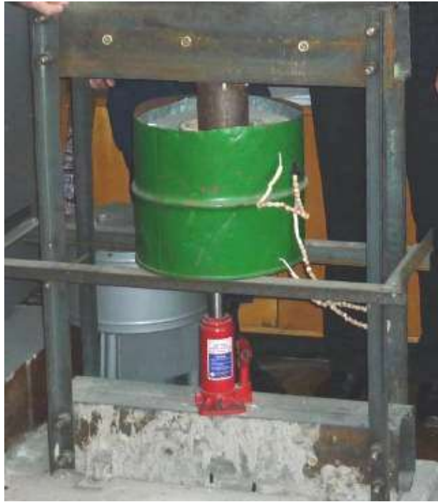
Рис. 2.13 – Установка для комбінованих випробувань циліндричних бетонних зразків
