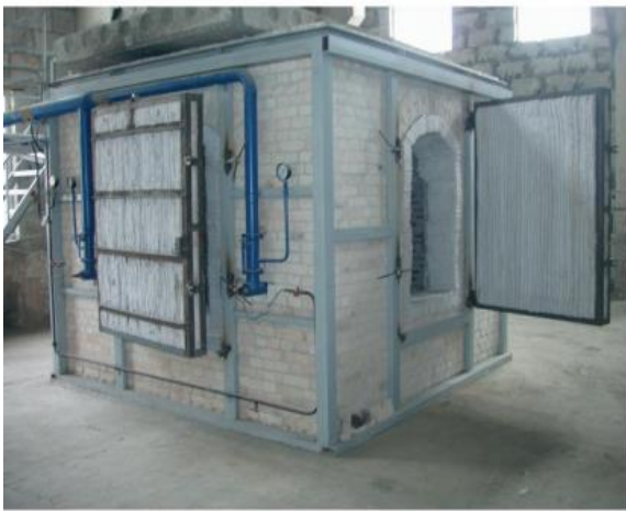
Рис. 2.1 Загальний вигляд та схема вогневої печі: 1 – корпус печі; 2 – пальники; 3 – канали видалення продуктів згорання; 4 – кришка печі; 5 – люки з дверима
