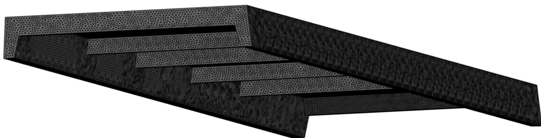
Рисунок 2 – Кінцево-елементна модель залізобетонної ребристої панелі покриття.
