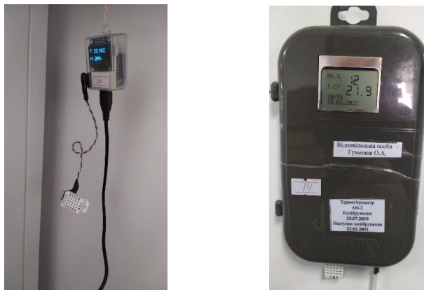
Рис. 4 Термогірометр AN-3 та AN- 2
