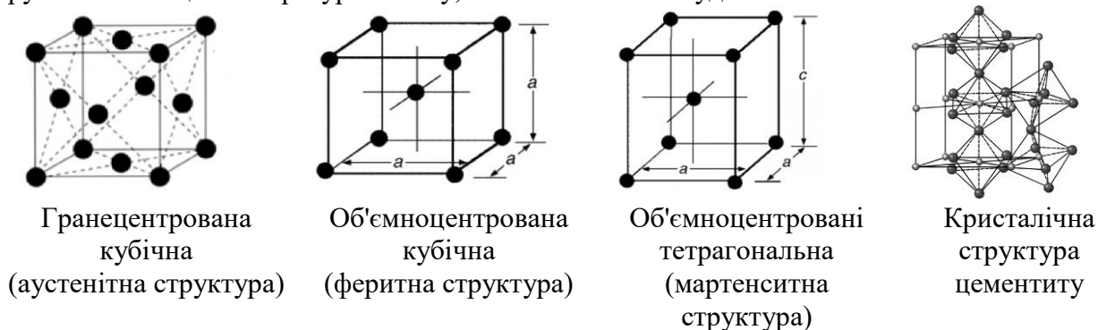
Рис. 3. Кристалічні ґратки для структурних складових
