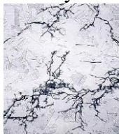
Тріщини від напруження (аустенитна нержавіюча сталь)
