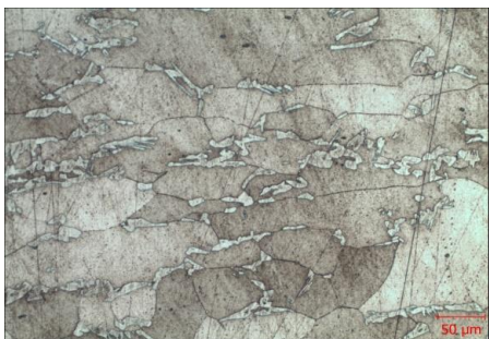
Рис. 4. Структура сталі 08X8CЮТч після гарячого деформування та рекристалізації, \times 200
