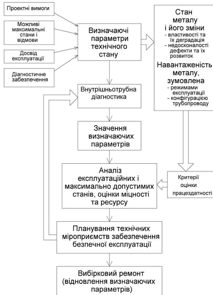
Рисунок 4 – Схема реалізації концепції безпечної експлуатації магістральних трубопроводів
