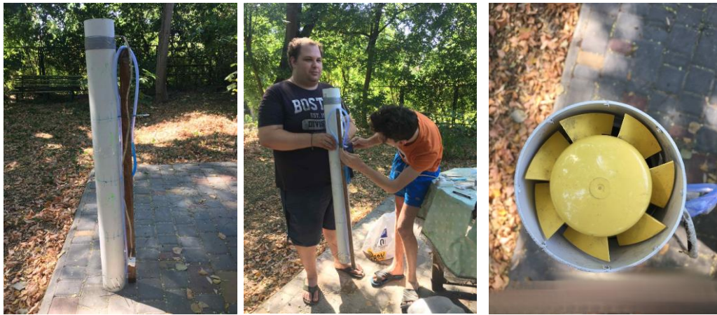
Рисунок 1. Експериментальне дослідження аеродинамічного опору щільного шару щєбня
