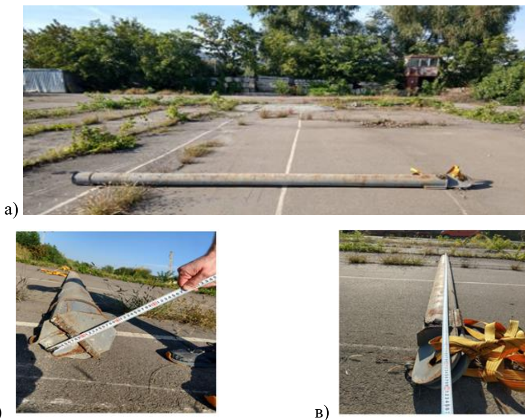
Рис. 2. Конструкція тестового зразка випробувань на вертикальну магнітну чутливість (а) і вимірювання діаметру (б) та довжини (в).
