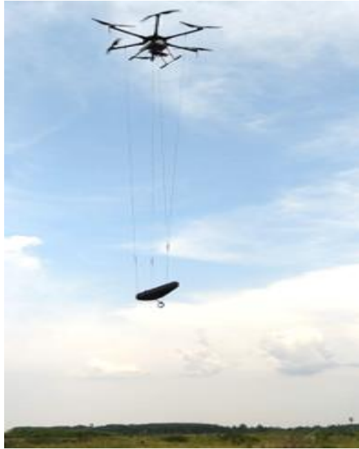
Рис. 1. Гібридна платформа БПЛА, оснащена підвісним магнітометром в захисному футлярі
