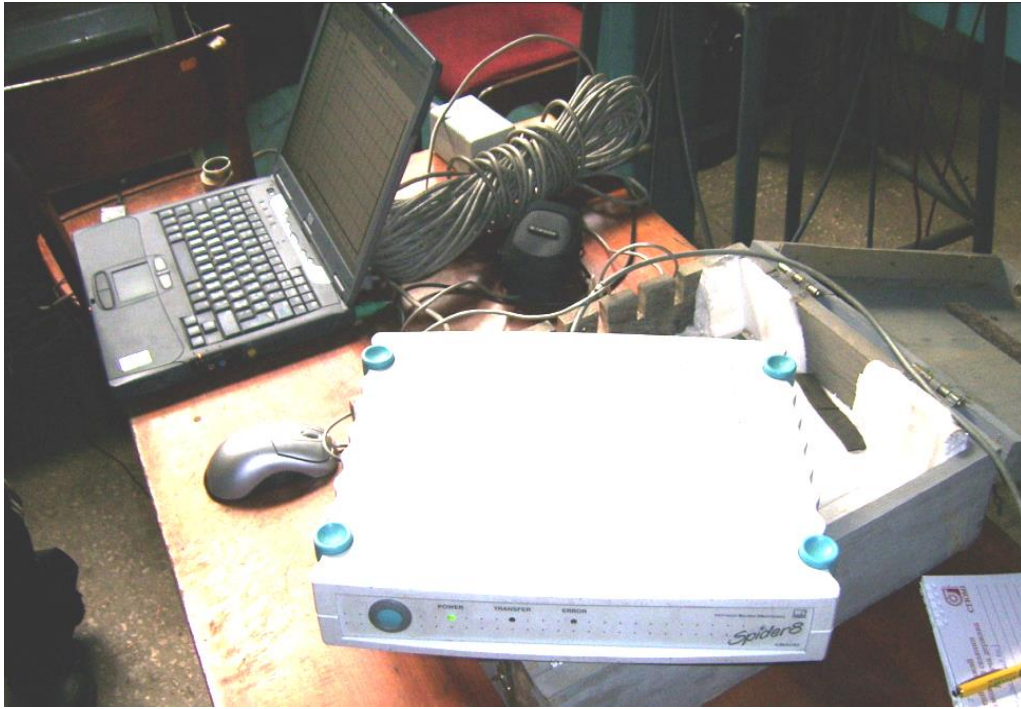
Рисунок 11. Підсилювач-перетворювач SPIDER 8-FO5254 та персональний
