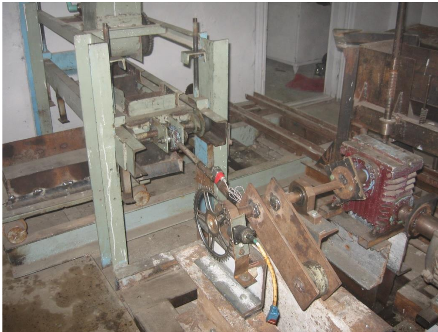
Рисунок 2. Дослідний стенд роликового формування з кривошипно-шатунним приводом
