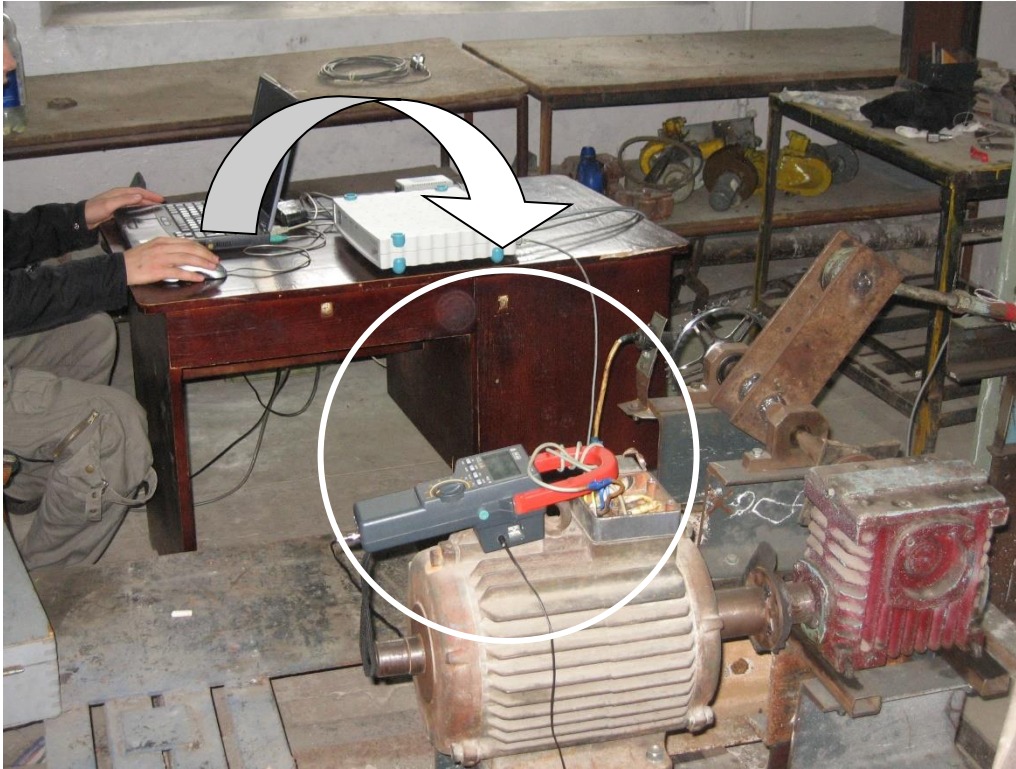
Рисунок 10. Розташування кліщів РК 435 для вимірювання потужності двигуна
