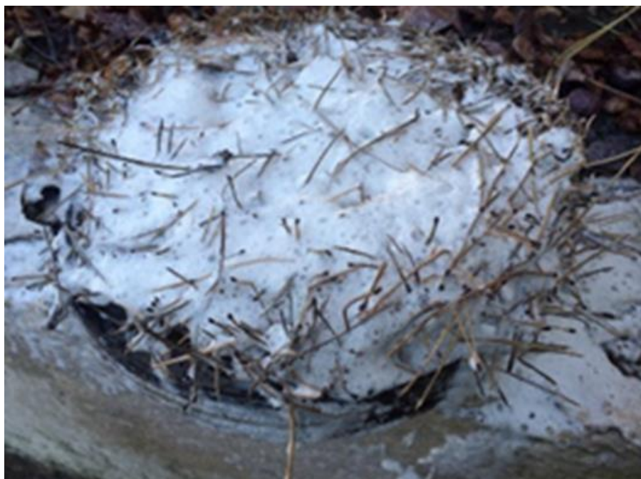
Рис. 3.2 – Результат обробки лісової підстилки ПУС: вуглеамонійна сіль + \text{Al}_2(\text{SO}_4)_3 при роздільно-одночасному способі подачі
