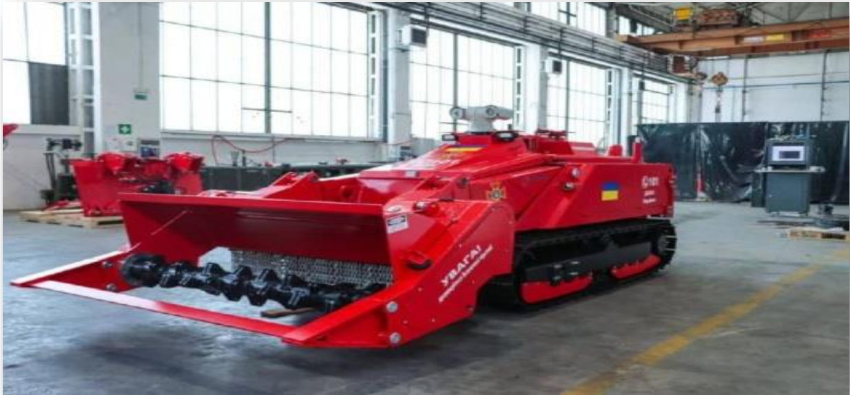
Рисунок 4 – Машина механізованого розмінування DOK-ING MV-10.
