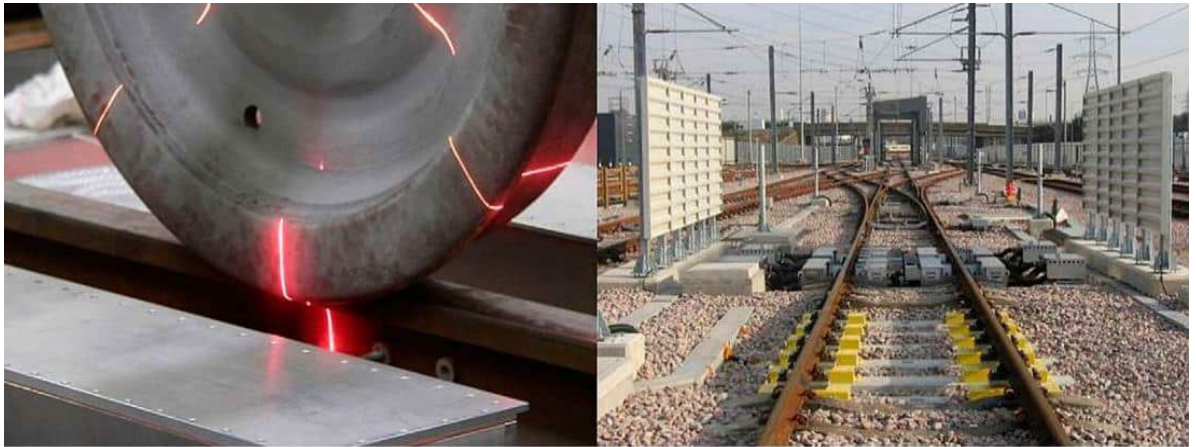
Рисунок 3 – Пристрій контролю геометричних параметрів колісних пар
