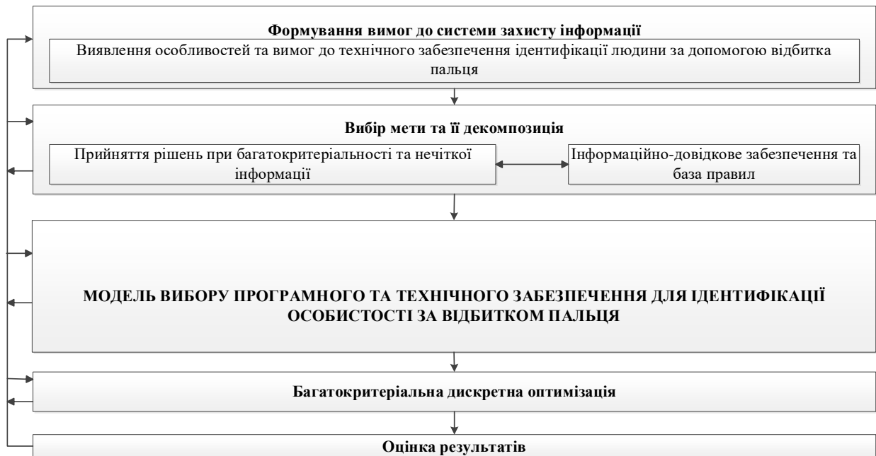
Рисунок 1 - Інформаційна технологія вибору програмного та технічного забезпечення для ідентифікації особистості за відбитком пальця
