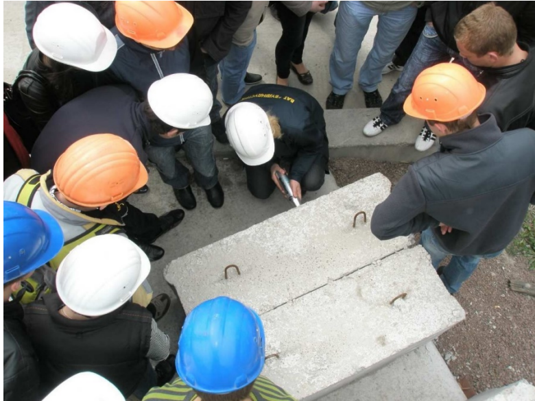
Рис. 2 – Дослідження міцності бетону молотком Шмідта.
