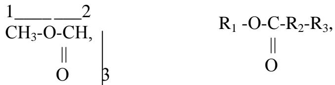
де 1, 2, 3 – структурні компоненти метил форміату (зв’язки C-O, C=O), довжина кожного прийнята  $l = 2$ ;
