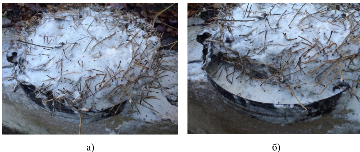
Рис. 1. Этапы эксперимента по подаче ПОС на лесную подстилку: а – обработанная лесная подстилка при одновременной подаче ПОС; б – обработанная лесная подстилка при последовательной подаче ПОС
