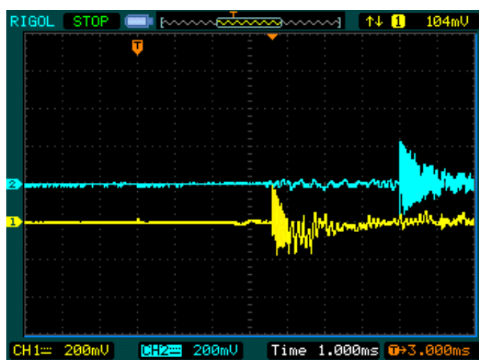
Рис. 4. Осцилограма імпульсів на п'єзодатчиках під час вильоту тіла масою 712 г з газодетонаційної установки: 1 – на п'єзодатчику № 1; 2 – на п'єзодатчику № 2
